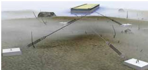
O SEAFLEX é um sistema de fixação elástica que fornece amarrações flexíveis e seguras em todas as condições atmosféricas, sem afetar o fundo marinho e exigindo baixa manutenção. A progressiva expansão do sistema de fixação proporciona um efeito de amortecimento suave, a ser regulada de acordo com as variações do nível de marés. O número de cabos de borracha e comprimento depende das forças activas (variações do nível do mar, vento, ondas, correntes e profundidade).
