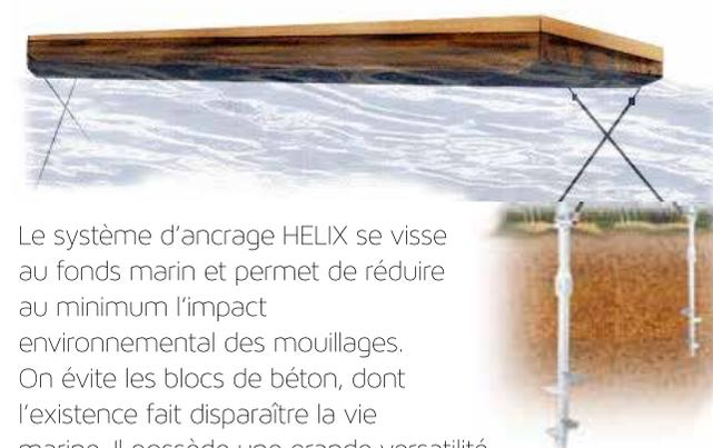
Le système d'ancrage HELIX se visse au fonds marin et permet de réduire au minimum l'impact
