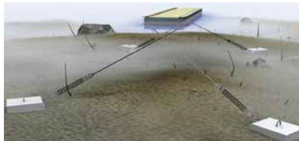
Le SEAFLEX est un système élastique qui offre des amarrages flexibles et sécuritaires par tous temps, qui n'affecte pas le fonds marin et requiert un entretien régulier faible. La progressive expansion du système d'amarrage offre un effet d'amortissement, et se règle en fonction des variations du niveau de l'eau. Le nombre de câbles de gomme et leur longueur dépendent des forces actives (variations du niveau de l'eau, vent, vagues, courant et profondeur).
